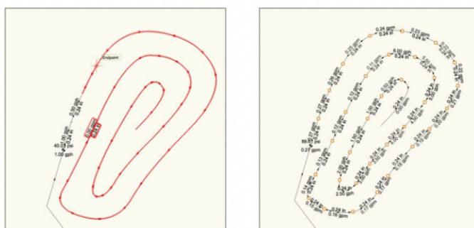
図28&29：ドリップラインに置かれたドリップチューブ（左）エミッタオブジェクトの間に表示されるフローと配管のデータ（右）
