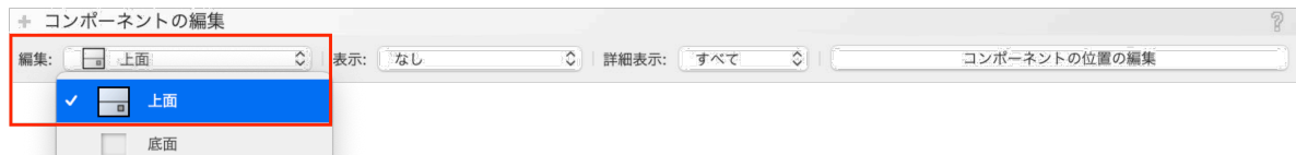
図15：編集ドロップダウンメニュー - コンポーネントの編集バー
