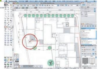
レイヤごとに図面を保存したり、PDF化した図面にスナップできる機能は、BIMのワークフローでの図面確認にも便利だ
