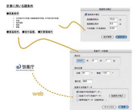
VectorWorksで設計した建物の3次元モデルに断面や材料、部位などの属性情報をインプットし、それに気象条件、室温条件、地中温度などの条件を適用してヒートアイランド現象の要因である敷地建物の表面温度を解析する
