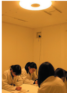
奈良女子大学内にある照明実験室での実験風景。連続調光・調色が可能なLEDシーリングライトを使った
