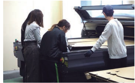
寺澤社長の指導のもとダンボールの性質を活かした作品の加工作業 本格的なレーザーカッターの加工も学生たちだけで操作
