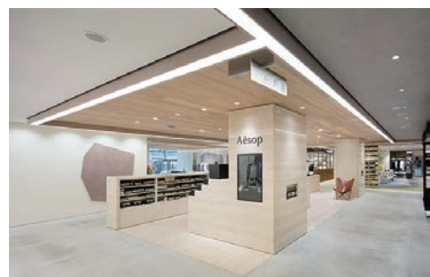
JR新宿駅直結の商業施設 NEWoMan。幅2.5mの通路の天井は中央部分にライン照明を設け、両側の店舗の天井を延長することをデザイン規定に盛り込んだ
