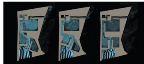
部屋の形や位置を変えながら通風シミュレーションで風通しの良い間取りを検討した(画像: © 株式会社 SUEP.)
