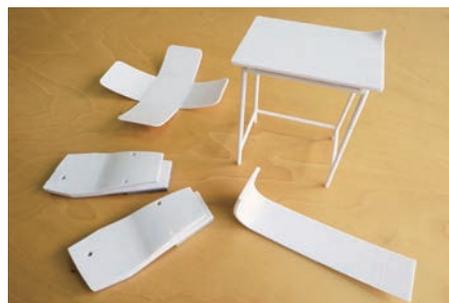
専攻科で成型合板技術を使用したプロダクトデザイン。最終デザインのモデリングデータを縮尺1/2から1/5程度のスケールモデルで出力してデザインの確認を行う。
