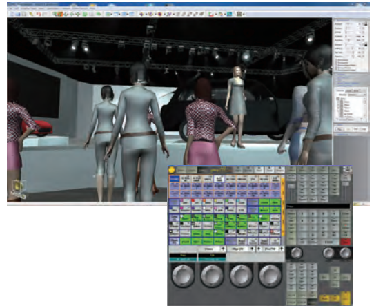
ムービングスポットを多用する現場でも、照明シミュレーションソフトと制御卓のオフラインシステムを利用する事でプリプログラムが可能となり、短期間の施工スケジュールの中でも完成度の高い演出を行う事が可能となってきた
