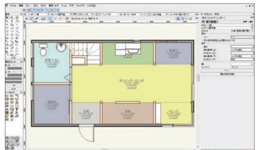
壁ツールを設定することで、基本設計で作成した壁を、実施設計段階で決定した仕様「内断熱通気工法」の壁に置き換えられる。
