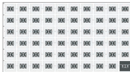
各階の平面図を並べて、避難性向をシミュレーションした様子。規模が大きかったため、平面上では人が小さなつぶになってしまい階段内の混雑の様子がわかりにくかった。
