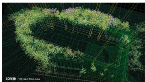
種まきプログラム：時間軸を加えた4次元空間でデザインしてゆく。30年後の状態をシミュレーションし、これをデザインプロセスに取り込む。
