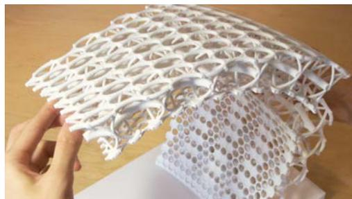
コンピューティショナル・デザインによる3Dプリント模型。先進テクノロジーを用いて従来では制作が難しかった形態モデルを実現。
