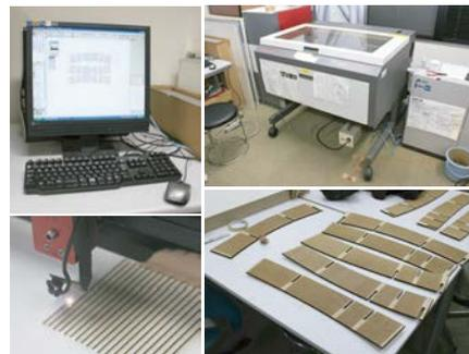
Vectorworksから直接レーザー加工機にデータを転送して木材をカット。豊橋技術科学大学でのデジタルファブリケーション技術の活用例。
