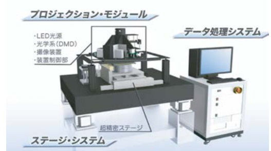
描画速度は早く100mm角の範囲を約20分で描画、装置の価格も従来と比べ数分の1から数十分の1、描画結果も描画分解能0.5μm、接合精度±0.5μm以下、重ね合わせ精度±1μm以下の高精度を実現したプロジェクション描画装置。（画像提供：ピーエムティー）
