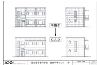
手描きとCADの立面図(教材:学芸出版社 新装版 初めての建築製図)。手描きで製図のルールを学んだ後、CADで同じ図面を描くことにより便利さを実感する。
