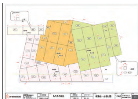
劇団民藝「八月の鯨」の道具帳から大道具製作用にVectorworksで作成した板敷き・台割り図。
