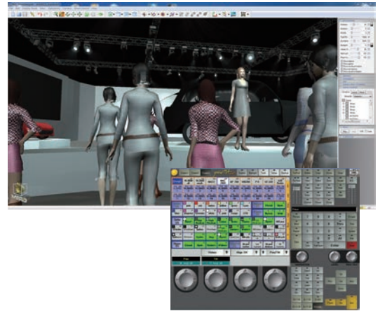
ムービングスポットを多用する現場でも、照明シミュレーションソフトと制御卓のオフラインシステムを利用することでプリプログラムが可能となり、短期間の施工スケジュールの中でも完成度の高い演出を行う事が可能となってきた
