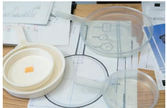
手書き、CAD、スチレンモデル、3Dプリンタモデル、各工程において最適なツールを活用する
