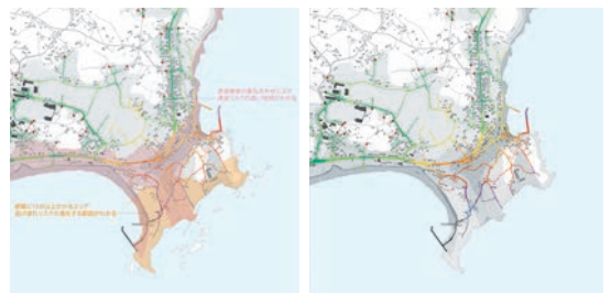
宮城県気仙沼市大谷地区を対象に作成した「逃げ地図」。今回と過去の浸水域を地図上に描き込み、ゼロ次避難地域と設定した地域から3分毎に歩行速度(分速43m)で到達する距離を色分けし表現。
