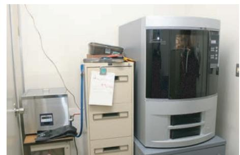
ABS樹脂を使用し、3Dモデルを短時間で造形するDimension 3Dプリンタ。3D CADから出力したSTLデータをソフトウェアで自動変換し、書類をプリントアウトする感覚で3Dモデルが完成する。
