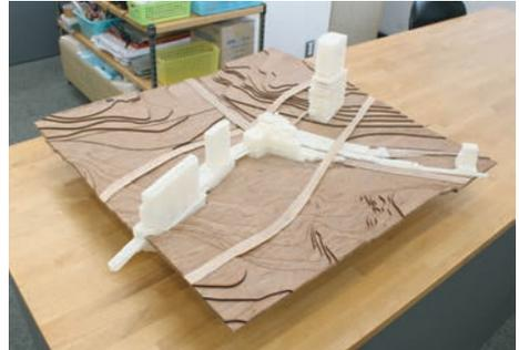
1000分の1の縮尺で表現した渋谷駅周辺。地形はレーザーカッターで制作し、ヒカリエなど大規模の建物は3Dプリンタを活用して、学生が制作している。地上だけでなく、地下も表現されている。
