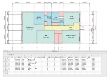
“建築・土木”メニューの図形からスペースを作成機能を用いれば、2D図面に情報を与えることができる。その後、BIMモデルとして発展させることも可能。
